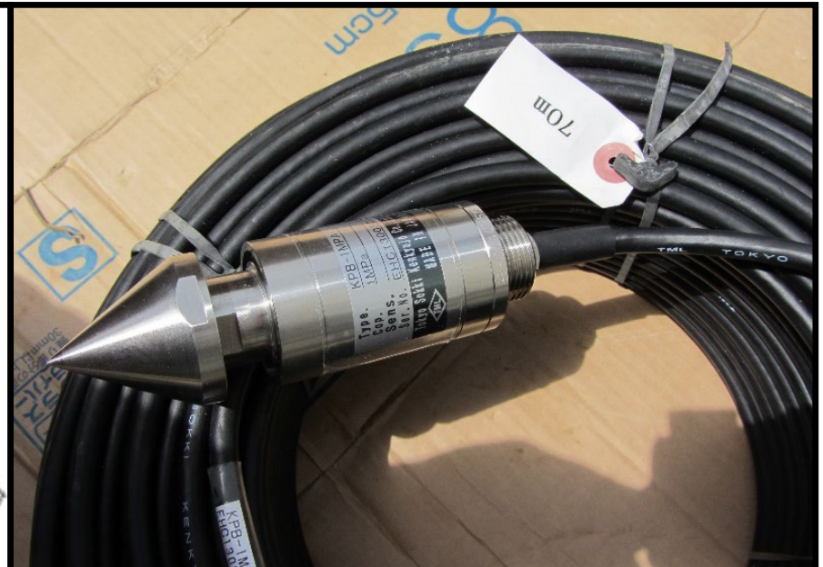
uređaj za mjerenje razine podzemne vode
