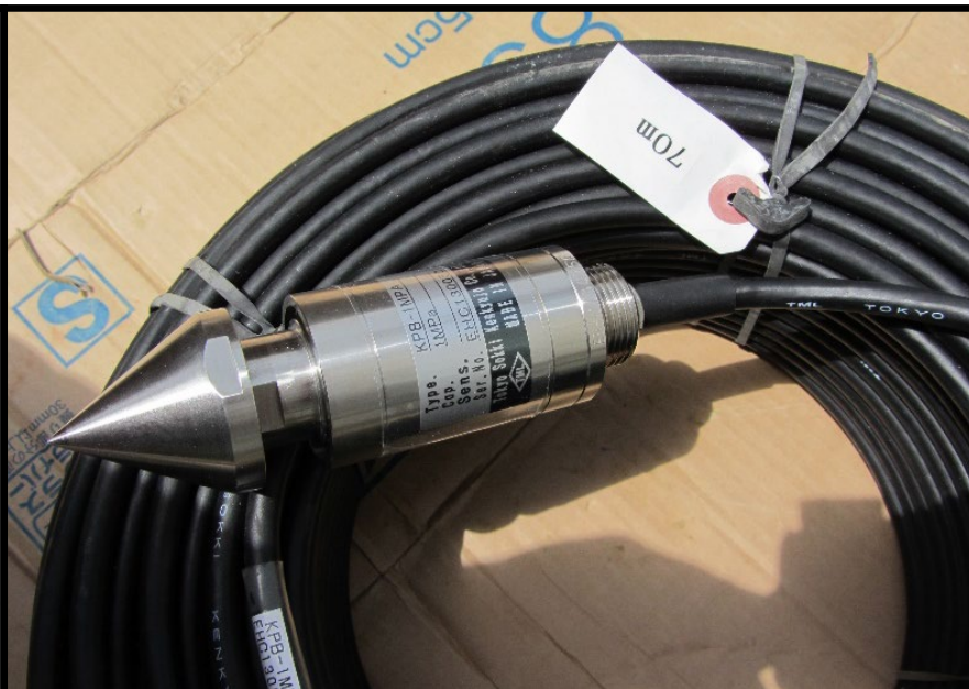
uređaj za mjerenje razine podzemne vode
